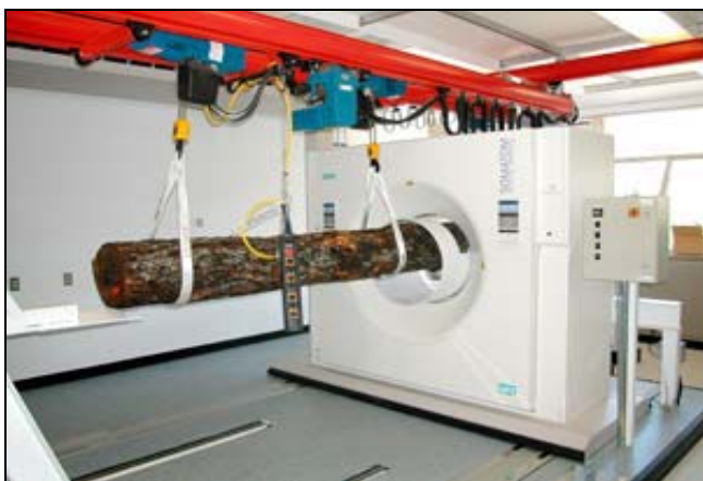
7-1. kép, 7-1. ábra: A kanadai Forintek Corporation által használt CT berendezés és működési elve. 44
