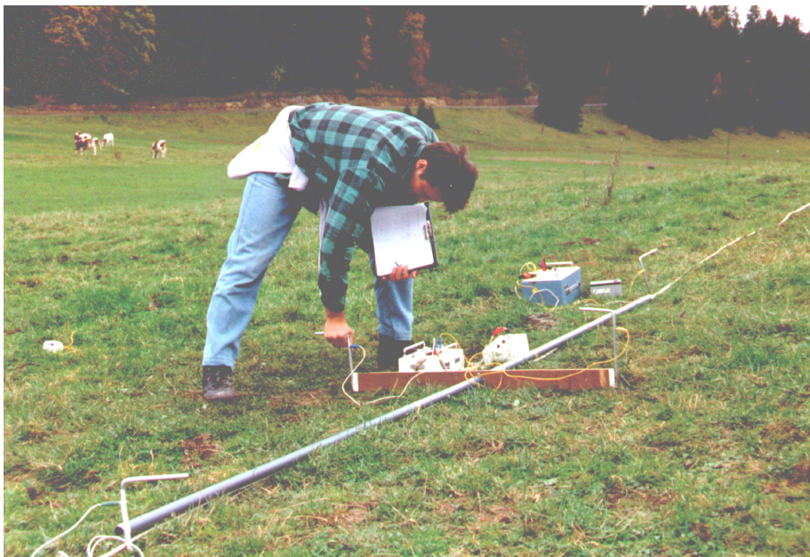
4.1. ábra. Terepi mérés geoelektromos null-elrendezéssel (Schlumberger elrendezés). A műanyag cső és a lécs a mérések geometriai pontosságának növelését szolgálja. A cső két végén az áramelektrodák, míg a lécs végeinél a potenciál-elektrodák találhatók
