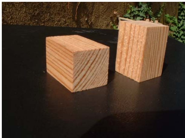
3.b.) Hegyvidéki minta próbatestek a fővizsgálathoz.
