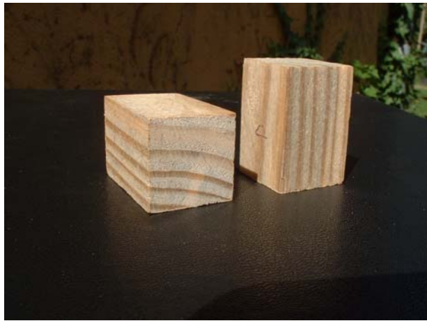
3.a.) Síkvidéki minta próbatestek a fővizsgálathoz.
