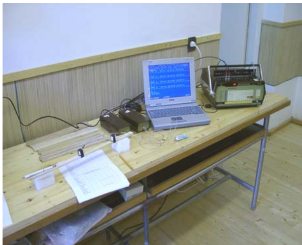
III.1. ábra Az AE mérőrendszer csillapítás mérése során
