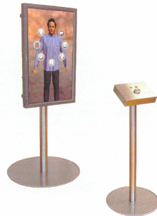
7-7. ábra A reutlingeni főiskola IntExMa testszkennere [97]
