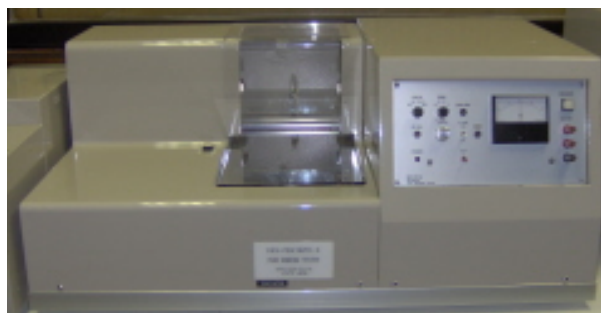
3-5. ábra A hajlítási vizsgálat mérési elve (balra) és a KES-FB2 készülék (jobbra) [110]
