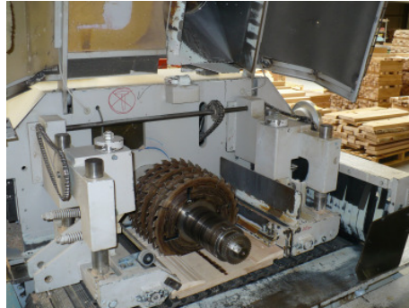
51. ábra: Ülőbútor Kft.: Sorozatvágó körfűrész lapjainak elhelyezése
