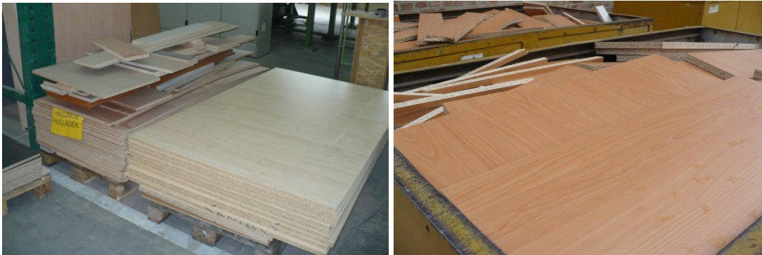
35. ábra: Visszaforgatásra váró táblásmaradékok és kiskonténer darabos forgácslaphulladékkal
