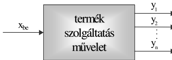
22. ábra: Egy bemeneti jellemző ( x_{be} - technológiai paraméter) hatása több gyártmányjellemzőre ( y_i - elvárt termékparaméterek)
