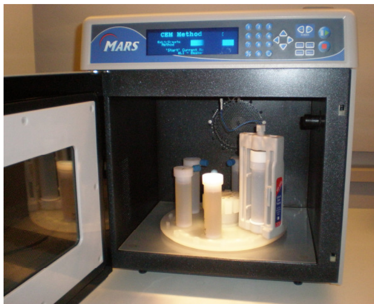
10a. ábra. Microwave Accelerated Reaction System, Model MARS™ mikrohullámú készülék kezelőterében teflonmintatartókban elhelyezett besugárzott tenyészetek és hőmérsékletmérő száloptikával felszerelt referencia-mintatartó
